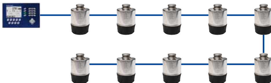
Réseau de capteurs numériques POWERCELL PDX (aucune boîte de jonction)
