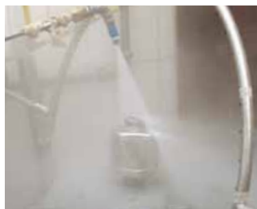
Les capteurs POWERCELL PDX ont subi avec succès des tests rigoureux d'arrosage à haute pression et d'immersion dans l'eau.
